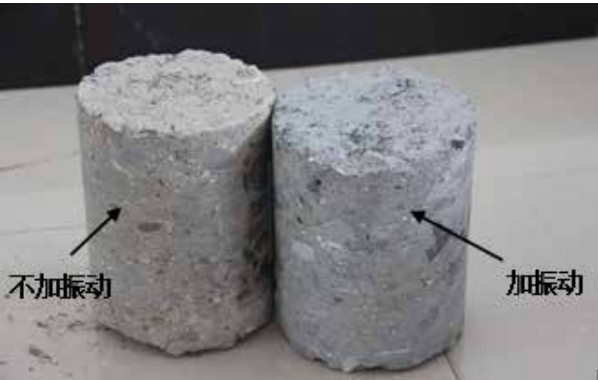
图 5 振动搅拌与普通搅拌现场取芯对比
